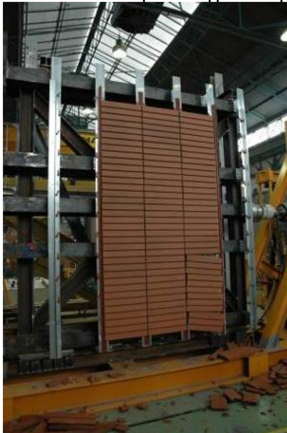
**Photographie n°6: essai d'excitation dans le plan du support – patte agrafe après essai à 5Hz et +/- 10 mm**
