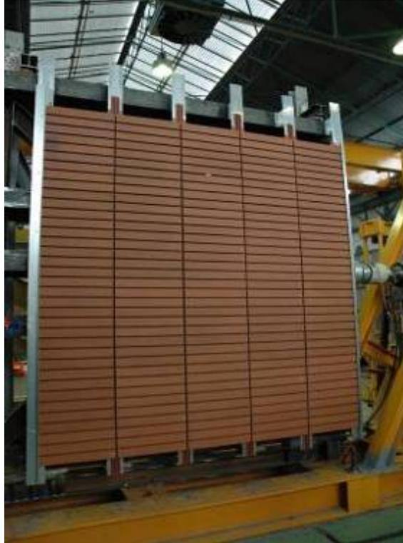
Photographie n°5 : essai d'excitation dans le plan du support – maquette après essai
