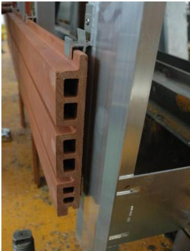
**Photographie n°2 : Montage de l'essai n°1- position des profils W**
