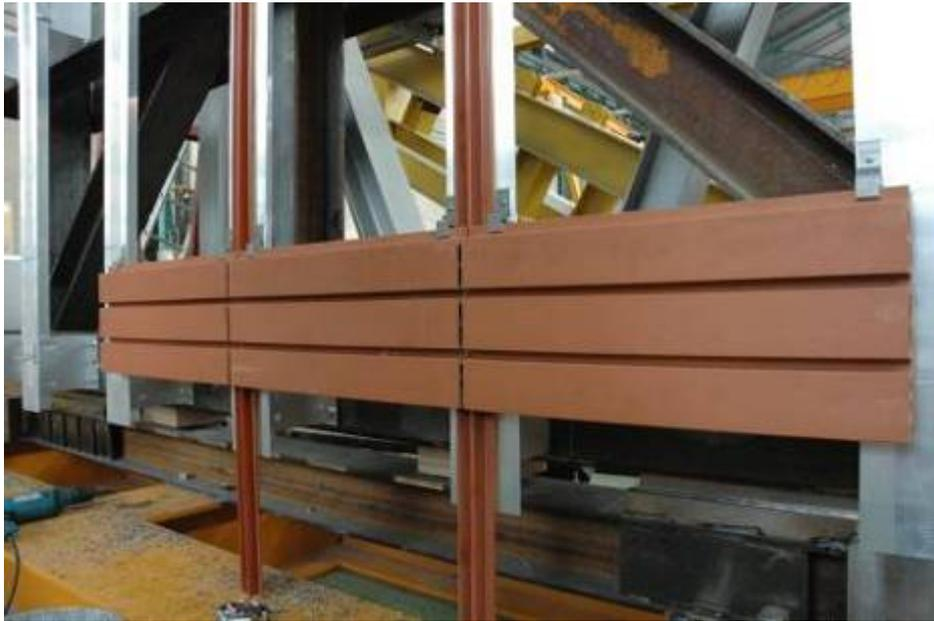
Photographie n°3 essai de mise en parallélogramme – position des équerres
