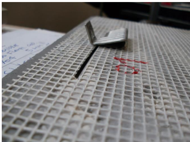
Foto 1: Gancio CLICK-UP-12. Sono visibili sia la piegatura da inserire nel materiale, sia quella utilizzata per il collegamento alla macchina di prova.
