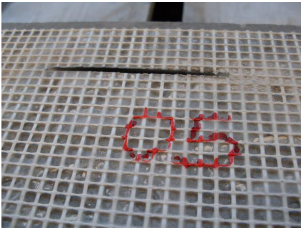
Foto 6: Gres Porcellanato con staffa estratta senza frattura a fine prova.
